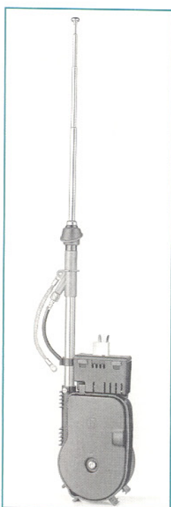
Bild 4: Motorantennen werden im Kotflügel montiert, benötigen jedoch relativ viel Platz unter dem Blech. Sie werden automatisch über den 12V-Steuerausgang des Autoradios aktiviert. (Foto: Hirschmann)
