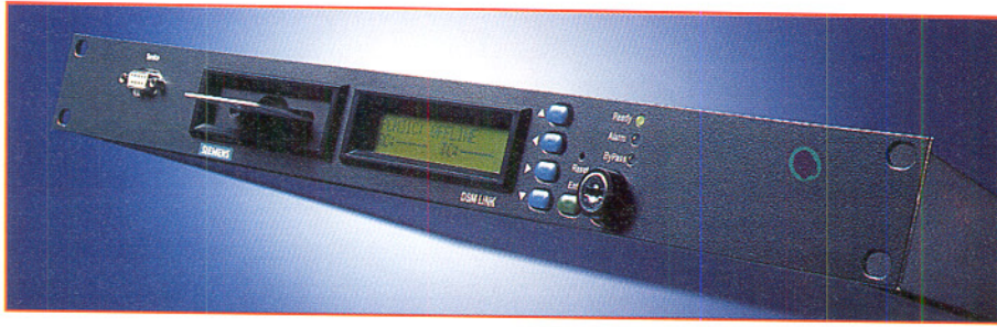
Bild 5: Abhörsichere Standleitungsverbindungen im firmeneigenen Computernetz bietet ein Datenschutz mit dem DSM Link von Siemens. Damit ist nicht nur Abhören verhindert, sondern auch Datenfälschung (Foto: SIEMENS AG)
