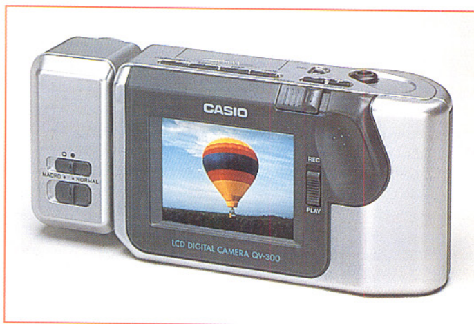
Bild 13: Ein schwenkbares Objektiv, wie es typisches Kennzeichen der Casio QV-Serie ist, macht das Fotografieren, z. B. über Kopf, noch leichter. Foto: Casio
